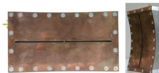
(d) 薄型曲面スロットアンテナ
