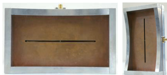
(c) 薄型平面スロットアンテナ
