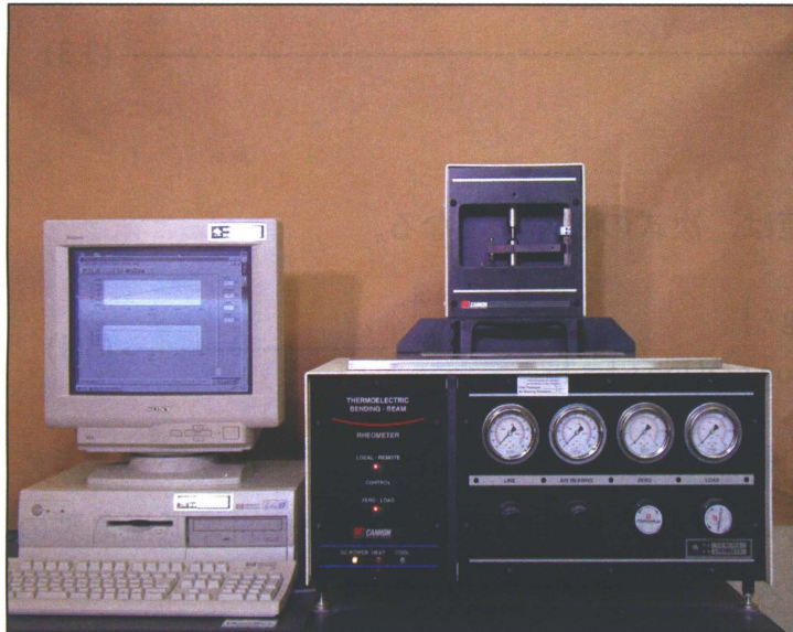
写真-3.1 BBR 試験機の外観
