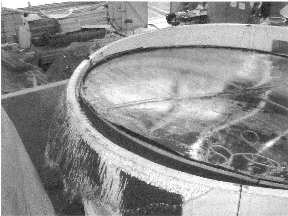
写真1 浮き屋根大変動時の越流状況
