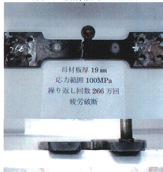
写真-4 破断状況 (100N/mm 2 )
