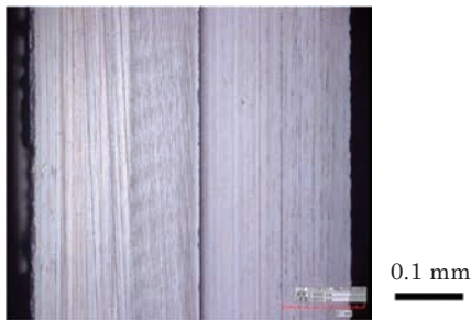
図3. SD法で切断したSi単結晶ウエハの切断面
