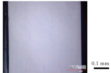
図5. バフ研磨後のSi単結晶ウエハの切断面
