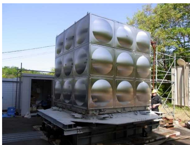
図-4.4 振動台に載せた大型の立方体実水槽
