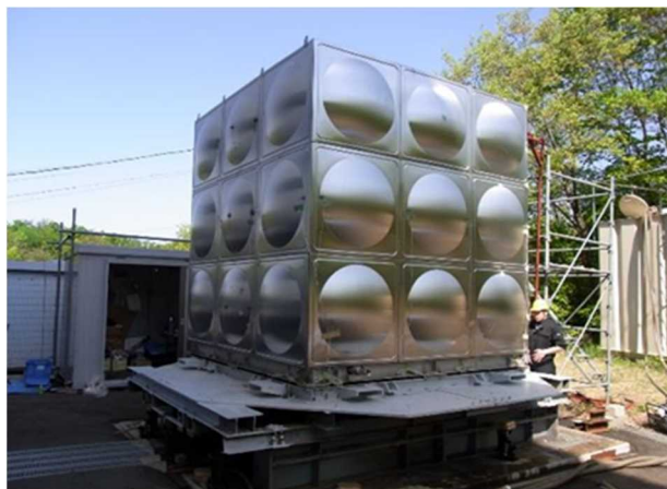
図-6.1 振動台に載せたステンレス鋼製大型実水槽
