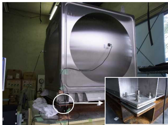
図-5.1 振動台上に載せたステンレス鋼製小型実水槽
