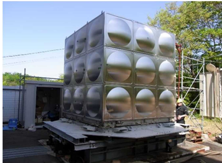
図-5.5 振動台に載せたステンレス鋼製大型実水槽
