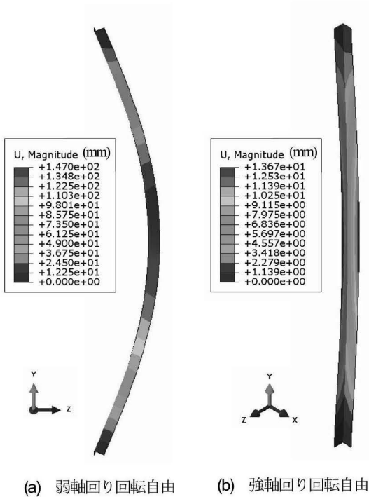
図-12 部材長4mの最大荷重時の変形モード例 (コンター図は変位の絶対値, 変形倍率5倍)
