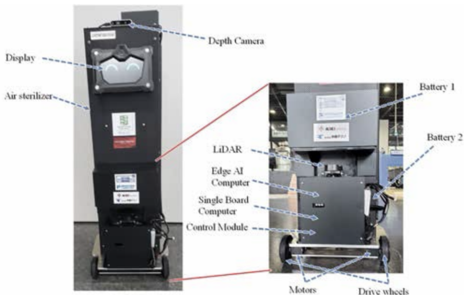
図 1 UVC 空気清浄機能を持つ自律移動ロボット AIT ステリロボットの構造
