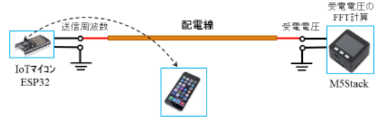
図3. 配線路探査器(手動切替)の全体図
