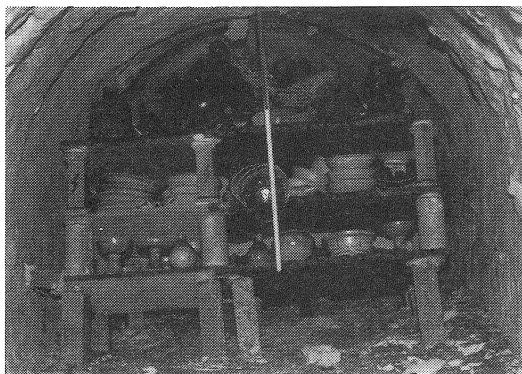
Fig. 4-4 熱電対保護管に附着した灰釉及び焼成品
